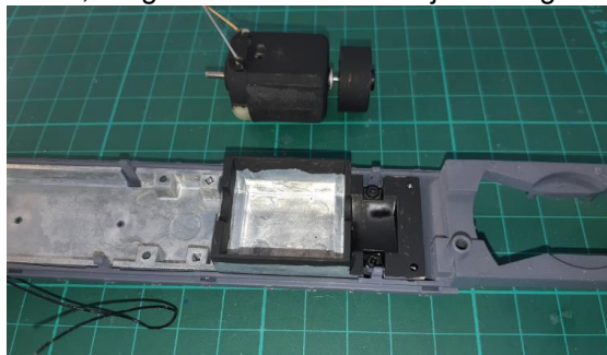
Motor, vliegwiel en motorsteun zijn zwart geverfd...
